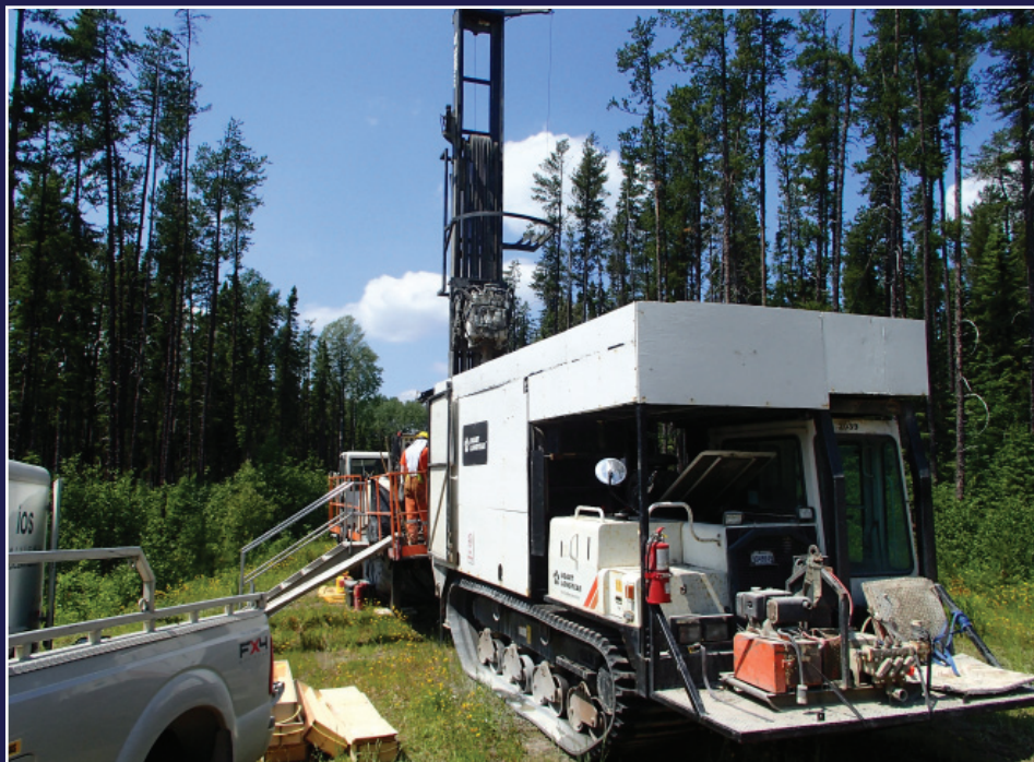
Foreuse autotractée de type Rotasonic en action (RO-434, 4 juillet 2013).
